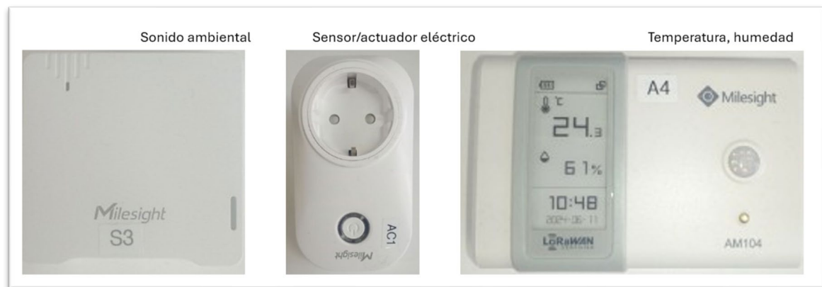
Figura 3. Sensores/Actuadores con tecnología LoRa
